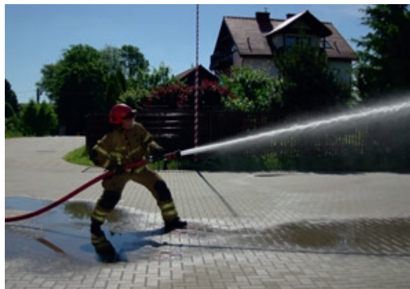
Fot. 35, 36, 37, 38: Technika podawania prądu zwartego o dużej wydajności. W przypadku modelu Akron 1720 wydajność maksymalna wynosi 475 l/min. Ułożenie odcinka oraz pozycja opisane w tekście powyżej umożliwiają swobodną pracę w wydłużonym czasie i minimalizację wysiłku fizycznego wkładanego w operowanie prądem gaśniczym.
