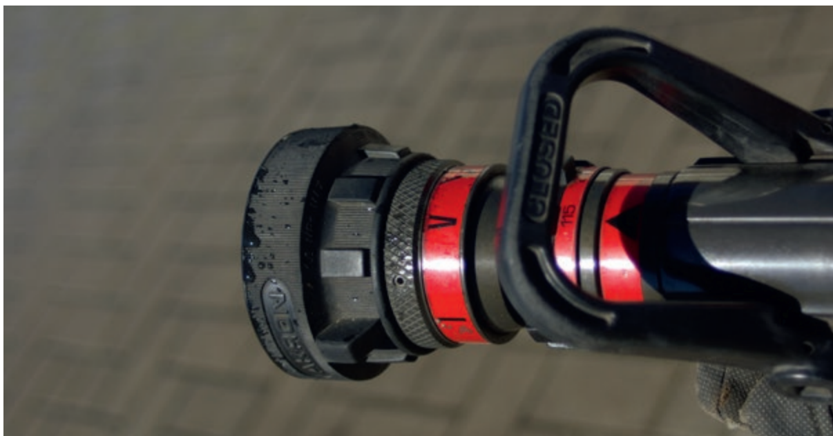
Fot. 22: Zbliżenie na widok ustawienia prądownicy do wykonania techniki krótkiego pulsu. Dużą zaletą modelu Akron 1720 jest to, że dzięki ustawieniom oznaczonym fabrycznie można ustawić dosyć dokładnie wszystkie niezbędne parametry prądu (wydajność, kąt rozproszenia). Jest to cecha rzadko spotykana wśród innych prądownic, pozwalająca na dokładniejszą, a więc bezpieczniejszą i skuteczniejszą pracę strażaka w warunkach stresu, ograniczonej widoczności, itp.
