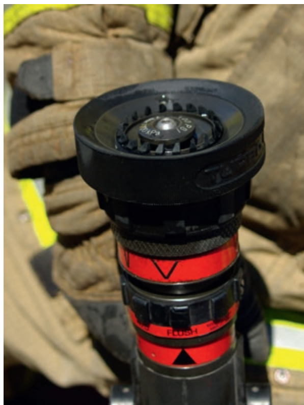
Fot. 1, 2: Po lewej: prądownica ustawiona na przepływ 115 l/min i prąd rozproszony. Po prawej: prądownica ustawiona na funkcję przepłukania („flush”) i prąd rozproszony. Przemieszczanie się trzpienia zmienia łączną powierzchnię wylotu dla podawanej wody, co działa niezależnie od pierścienia regulującego kształt wydostającego się strumienia wody.
