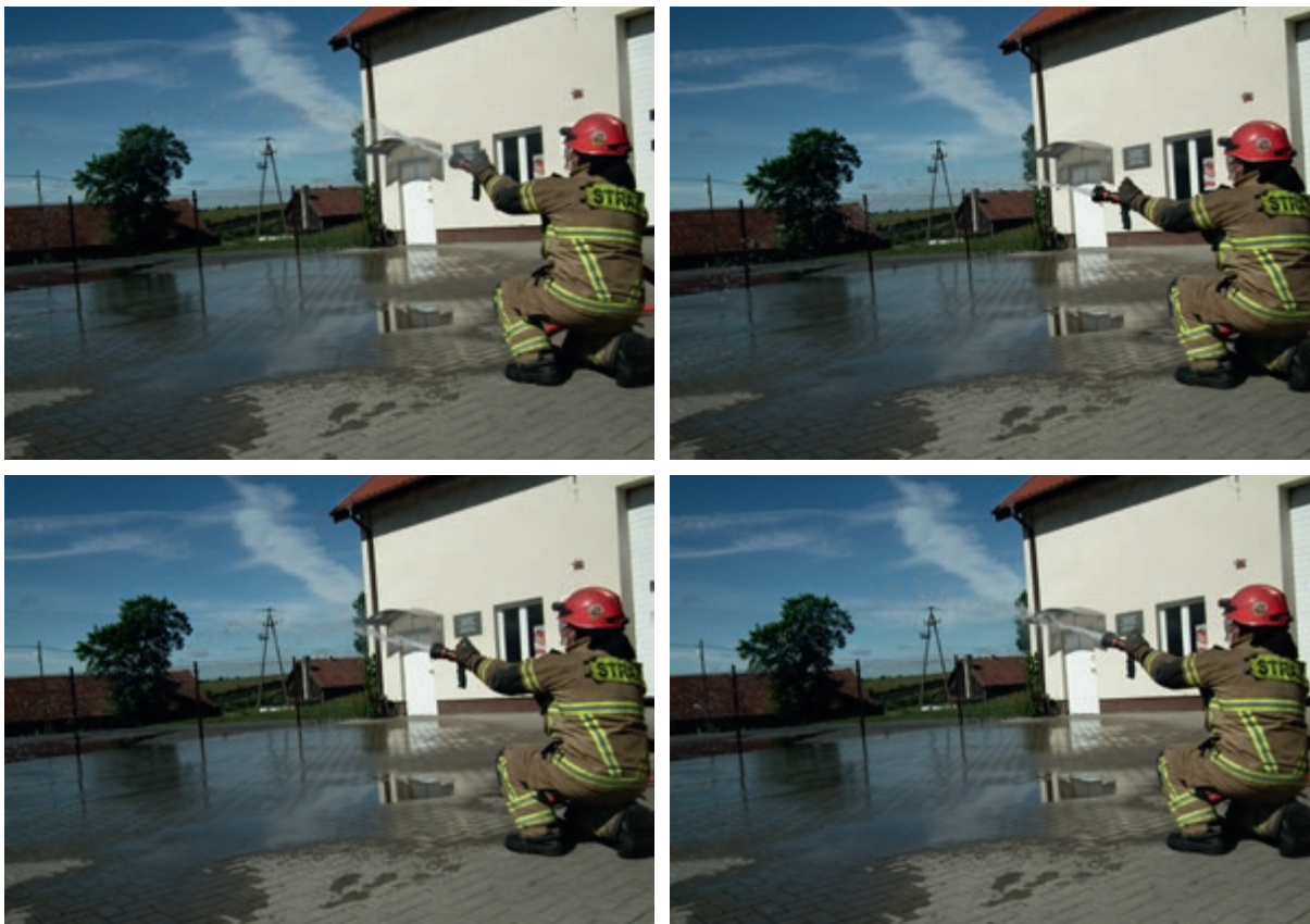
Fot. 31, 32, 33, 34: Technika malowania, czyli wysyłaniem łobem niewielkich ilości wody przy niepełnym i płynnie zmieniającym otwarciu prądownicy w celu chłodzenia nagrzaných powierzchni palnych.
