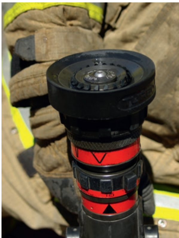
Fot. 1, 2: Po lewej: prądownica ustawiona na przepływ 115 l/min i prąd rozproszony. Po prawej: prądownica ustawiona na funkcję przepłukania („flush”) i prąd rozproszony. Przemieszczanie się trzpienia zmienia łączną powierzchnię wylotu dla podawanej wody, co działa niezależnie od pierścienia regulującego kształt wydostającego się strumienia wody.
