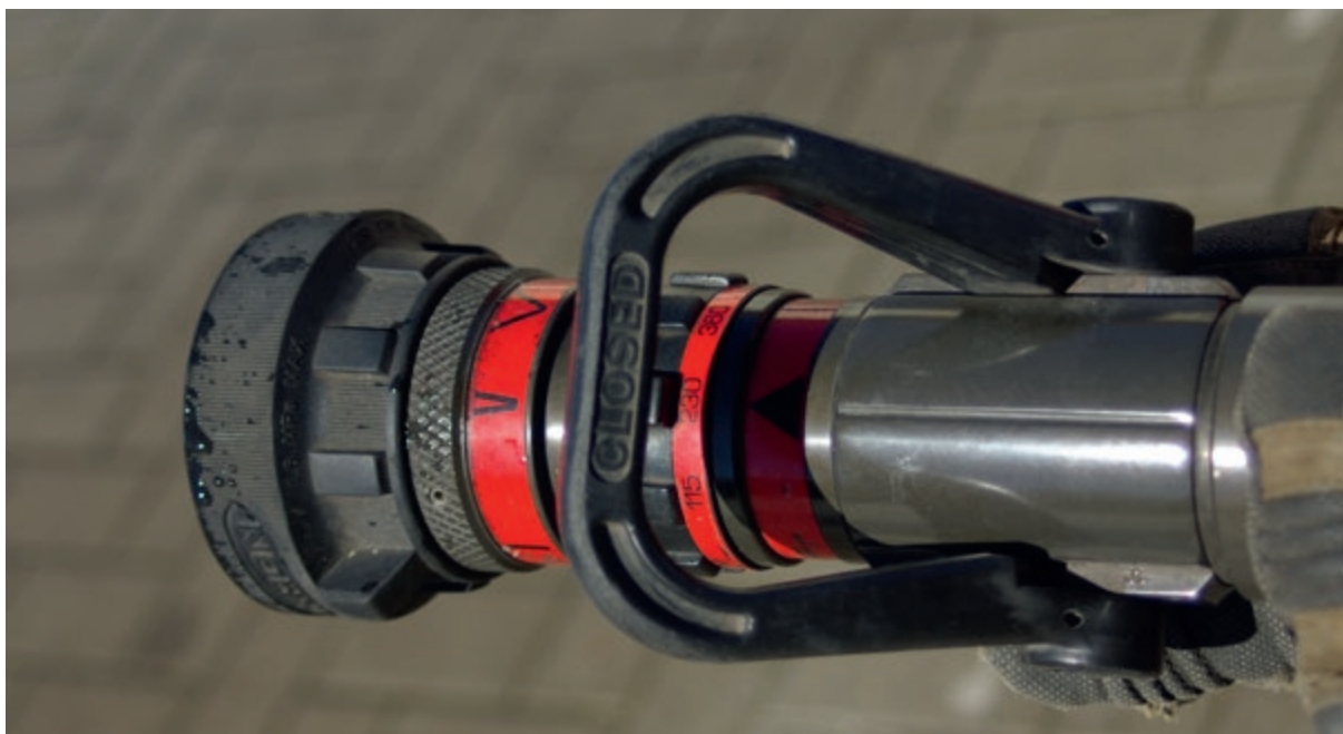
Fot. 23: Zbliżenie na widok ustawienia prądownicy do wykonania techniki długiego pulsu. Podobnie jak przy krótkim pulsie, zaletą modelu Akron 1720 jest łatwość ustawienia optymalnych parametrów prądu dzięki ustawieniom fabrycznym prądownicy. Podczas zmiany wydajności w prądownicach typu TURBO dochodzi najczęściej do zmiany kąta rozproszenia. W niektórych modelach prąd zawęża się (efekt pożądaný), a w innych rozszerza (efekt niepożądany). Jak wspomniano Akron 1720 ustawia automatycznie bardzo dobre parametry prądu gaśniczego i wystarczy jedynie ustawienie wydajności na 230 l/min oraz ustawienie pierścienia regulacji kąta rozproszenia w ustawieniu środkowym (identycznie jak dla krótkiego pulsu), aby uzyskać dobre ustawienie prądownicy. UWAGA! Każdy strażak powinien dokładnie poznać na ćwiczeniach prądownice używane w jego jednostce, aby w warunkach bojowych uniknąć zbędnych trudności z regulacją, mogących prowadzić do sytuacji niebezpiecznych (nieskuteczne chłodzenie gazów pożarowych, wytwarzanie nadmiaru pary itp.)
