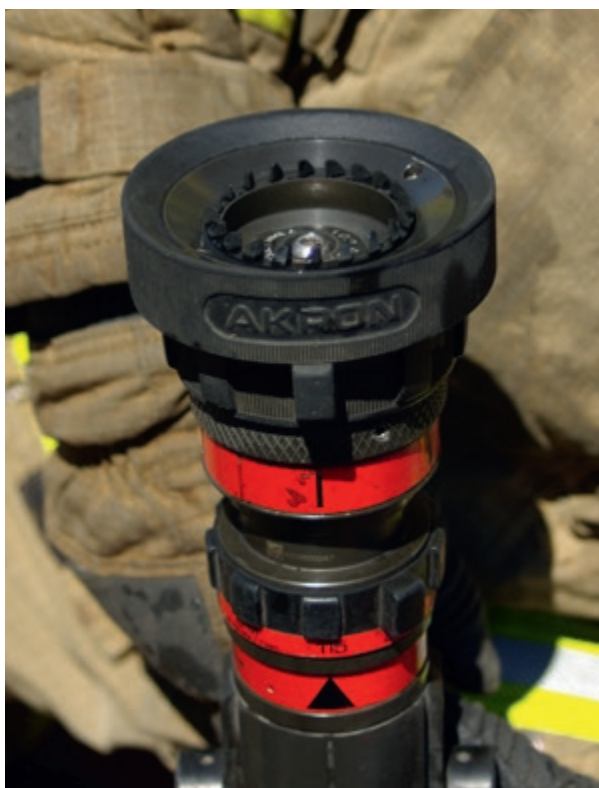
Fot. 3, 4: Po lewej: prądownica ustawiona na przepływ 115 l/min i prąd zwarty. Po prawej: prądownica ustawiona na funkcję przepłukania („flush”) i prąd zwarty. Przemieszczanie się trzpienia zmienia łączną powierzchnię wylotu dla podawanej wody, co działa niezależnie od pierścienia regulującego kształt wydostającego się strumienia wody.
