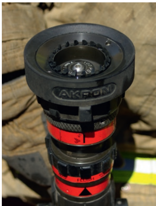
Fot. 3, 4: Po lewej: prądownica ustawiona na przepływ 115 l/min i prąd zwarty. Po prawej: prądownica ustawiona na funkcję przepłukania („flush”) i prąd zwarty. Przemieszczanie się trzpienia zmienia łączną powierzchnię wylotu dla podawanej wody, co działa niezależnie od pierścienia regulującego kształt wydostającego się strumienia wody.
