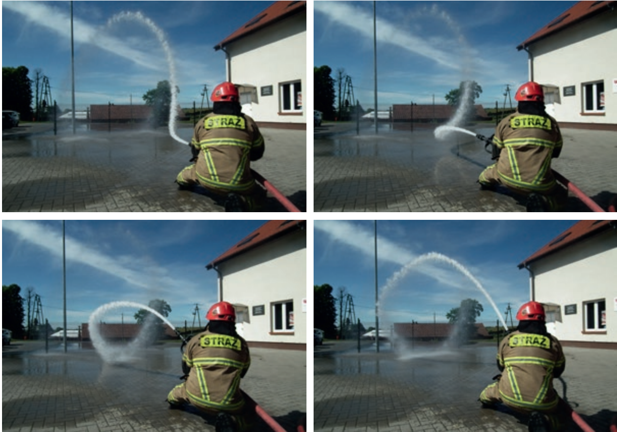
Fot. 51, 52, 53, 54: Technika omiatania prądem zwartym. Przy dynamicznych ruchach powstają kropelki wody dodatkowo chłodzące gazy pożarowe, chociaż ich jakość (rozdrobienie) jest znacznie gorsza, niż w przypadku prądu rozproszonego z prądownicy TURBO. W technice ważne jest szerokie omiatanie prądem gaśniczym, aby woda trafiała na wszystkie 4 powierzchnie przed nacierającą rotą (sufit, 2 ściany i podłogę).
