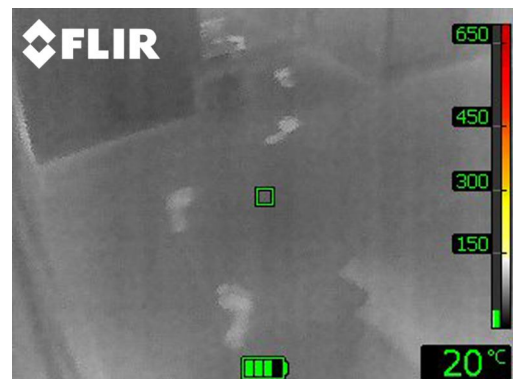
Fot. 5: Termogram przedstawiający odcisk stóp ludzkich na posadzce po przejściu na bosą. Termogram w kolorystyce monochromatycznej.
