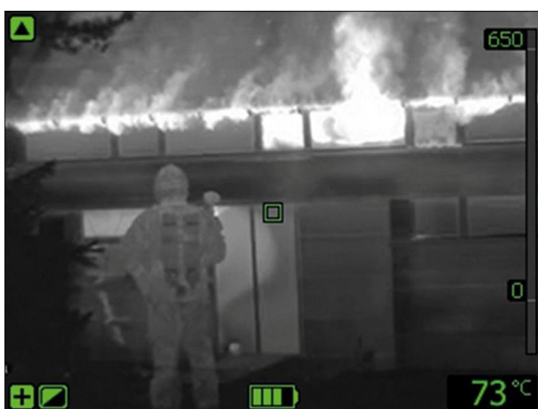
■ Fot. 20 Przykładowy termogram w trybie czarno-białym. [Źródło: www.flir.com]
