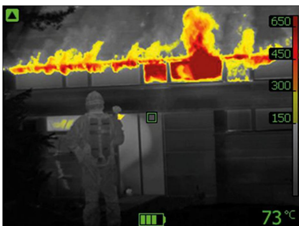
■ Fot. 19: Przykładowy termogram w trybie podstawowym. [Źródło: www.flir.com]
