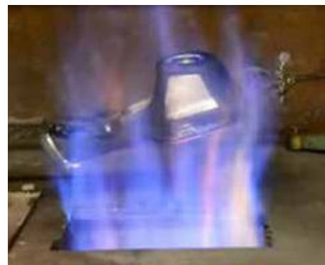
■ Fot. 17: Test wytrzymałościowy kamer termowizyjnych FLIR Seria-K. (Źródło: www.flir.com )
